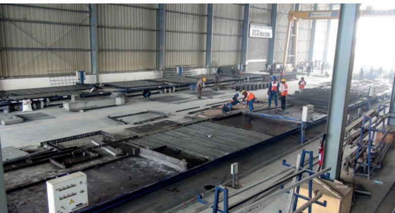
Produção de lajes treliçadas e elementos especiais na instalação de elementos de concreto pré-moldado da Weckenmann em Bharat City, Índia.
