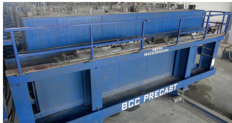
Uma das duas baterias de moldagem para paredes interiores e exteriores.
