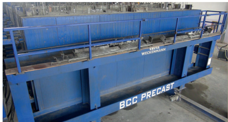
Une des deux batteries de coffrage pour les parois intérieures et extérieures.
