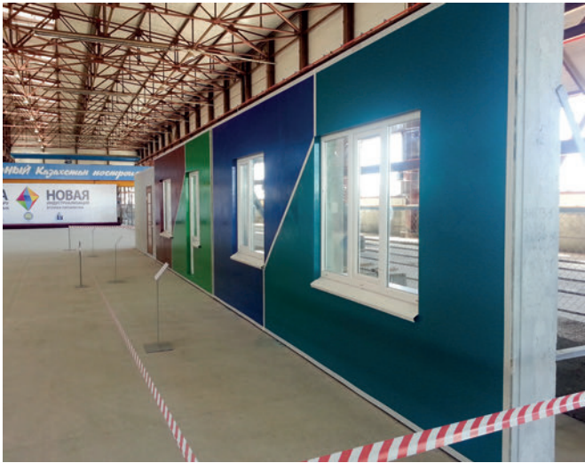
Готовы к сборке на стройплощадке: стеновые панели с оконными проемами
