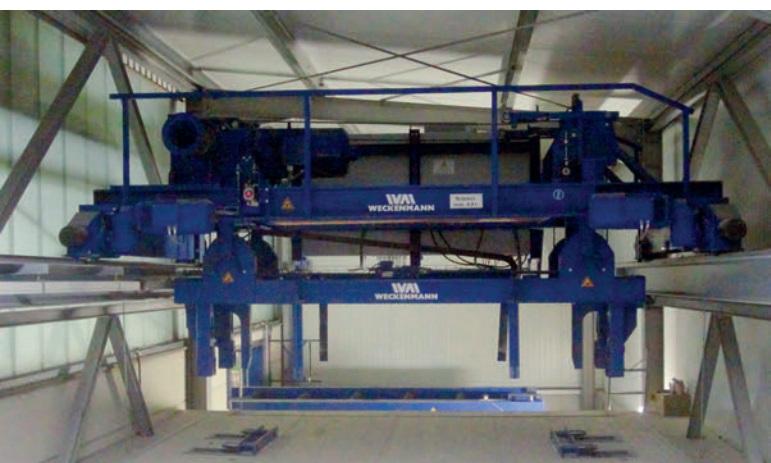
Полностью автоматический кран-укладчик
