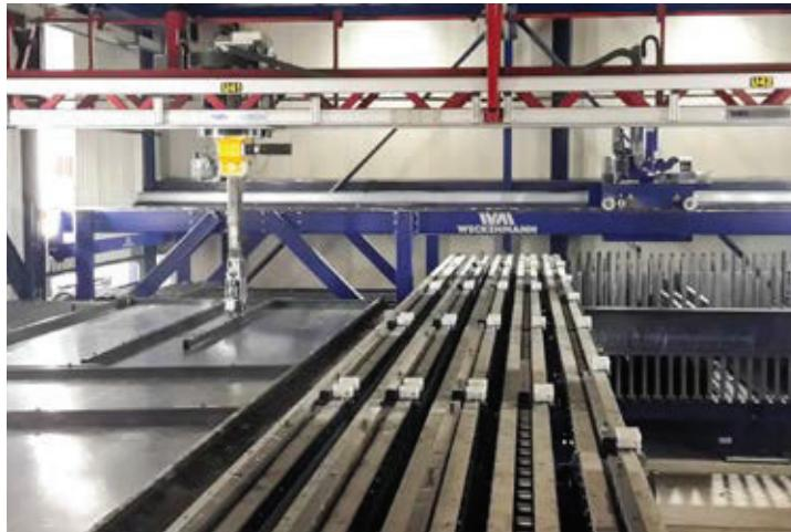
После модернизации: опалубочное оборудование с новыми шаговыми роликовыми конвейерами и накопителем фирмы Weckenmann
