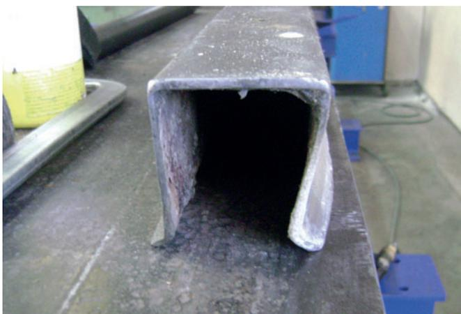
Avant rénovation des systèmes de coffrage : coffrages déformés et bosselés
