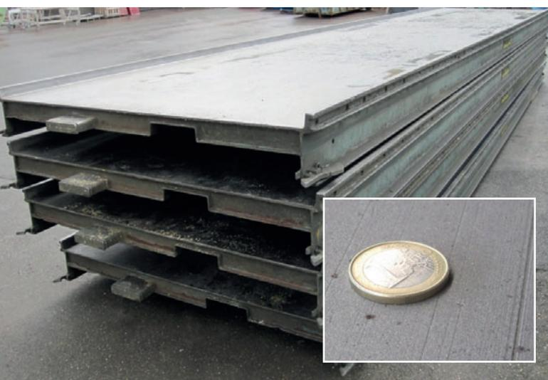
*Surfaces de coffrage de palettes de mauvaise qualité avant rénovation : rayures profondes et surfaces de coffrage irrégulières ; manque de peinture*
