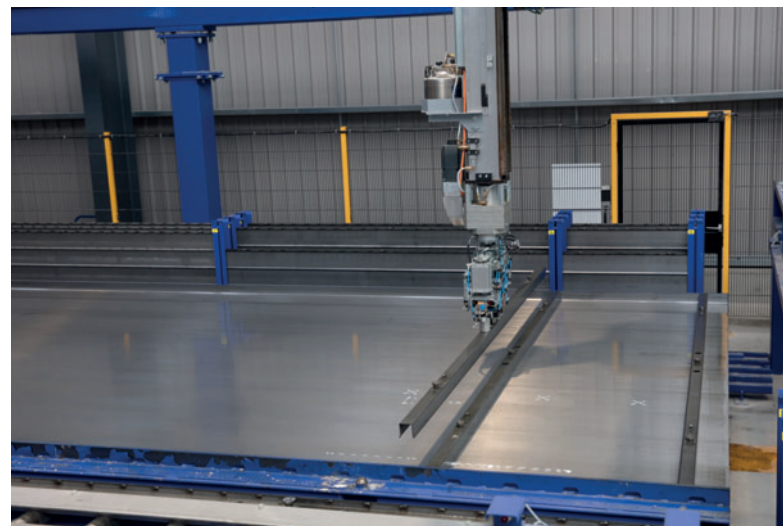
Опалубочный робот на заводе Keegan Precast Ltd.
