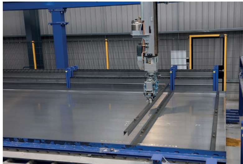
Keegan Precast 公司的模板机械手
