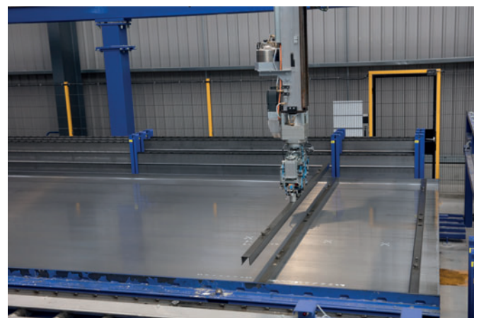
Einschalroboter bei Keegan Precast Ltd.
