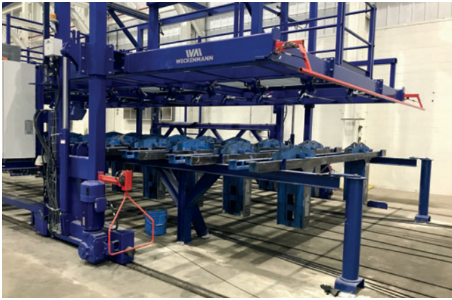
Carrinhos de armazém (puxar cabos, manipular batentes transversais)
