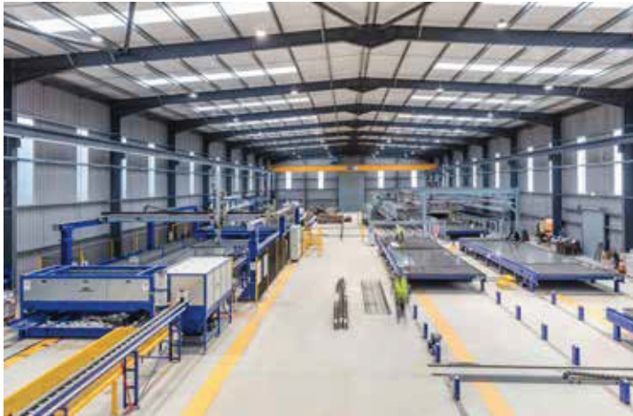
Pallet circulation system at Keegan Precast in Ireland Die Umlaufanlage bei Keegan Precast in Irland
