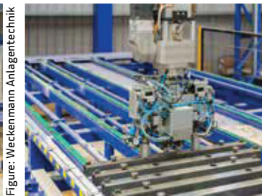
Shuttering robot Schalungsroboter
