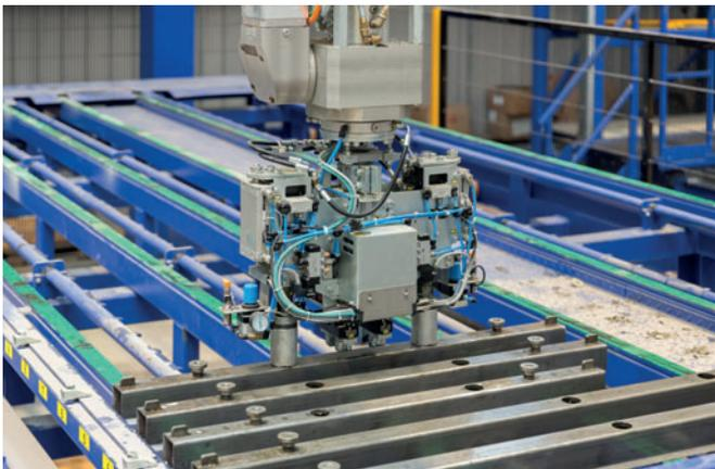
Robot de encofrado
