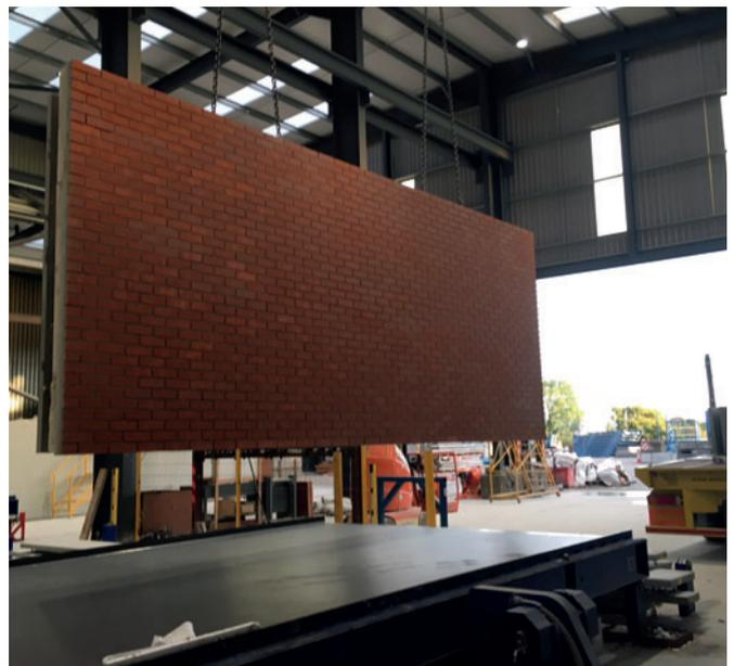
Prefabricado de hormigón con ladrillos de clínker.
