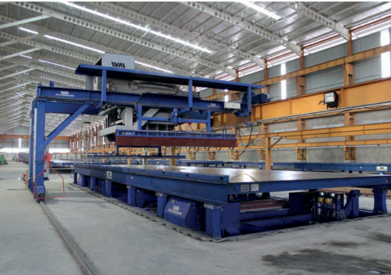
混凝土摊铺机与模板托盘和压实站
