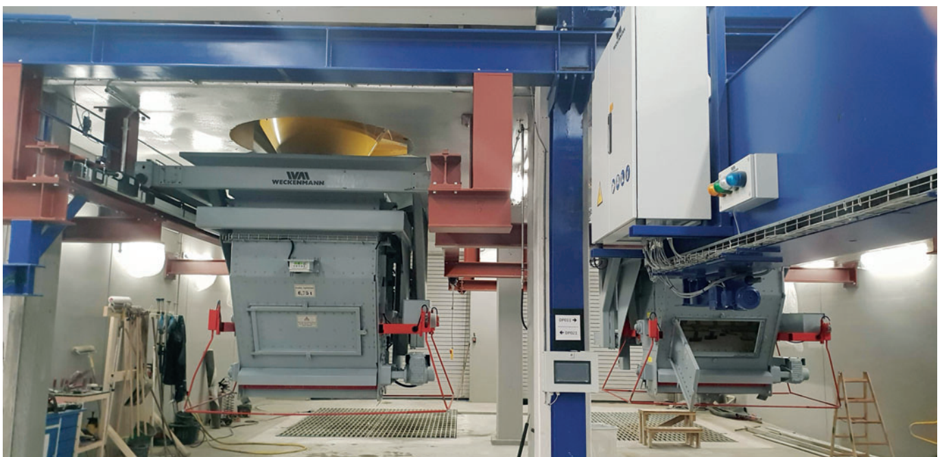
Distribuidor de hormigón con dos cubas
