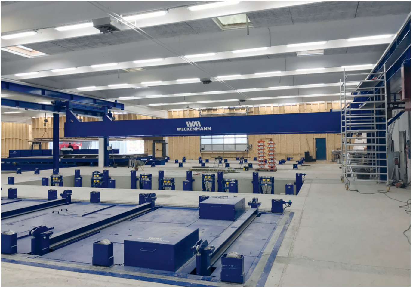
Estación vibradora Weckenmann y técnica de vibración MagVib
