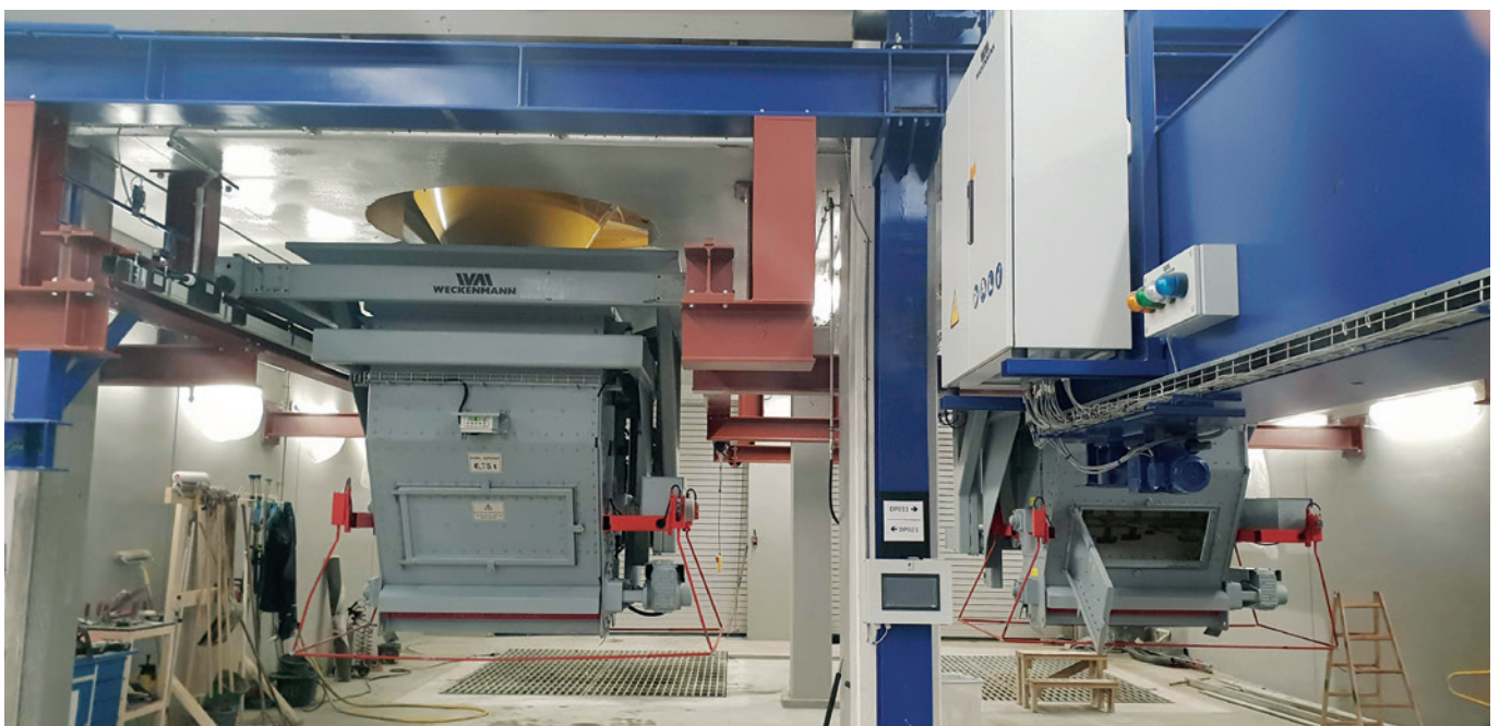
带有两个桶的混凝土分配器
