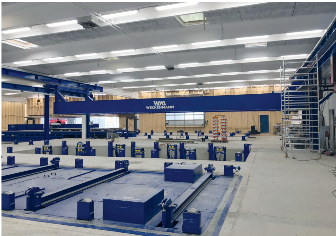
Weckenmann Schüttelstation und MagVib Rütteltechnik
