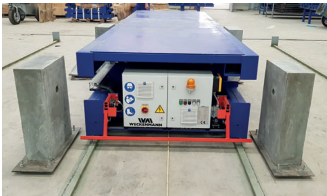
Chiot transfert avec plate-forme relevable par commande hydraulique, pour la prise en charge des piles de dalles
