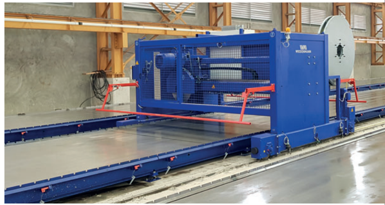
Scie à torons de précontrainte
