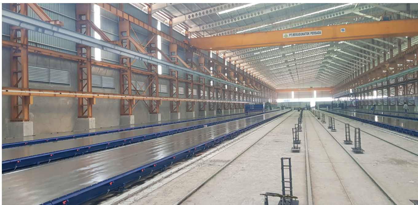
Six bancs de production disposés en parallèle avec une allée logistique centrale
