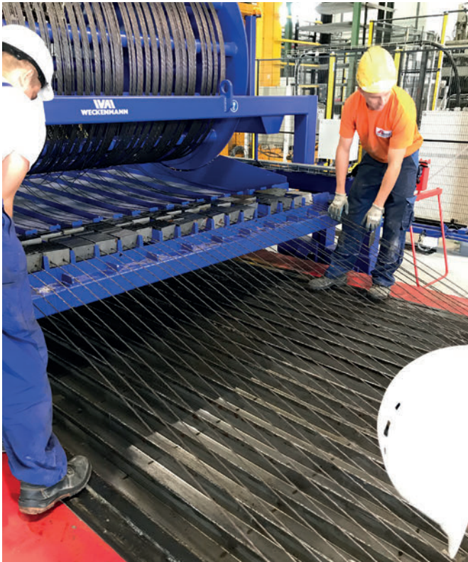
El tambor de transporte para cordones de pretensado
