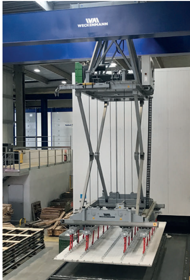
Abhebegerät für Elementdecken von Weckmann
