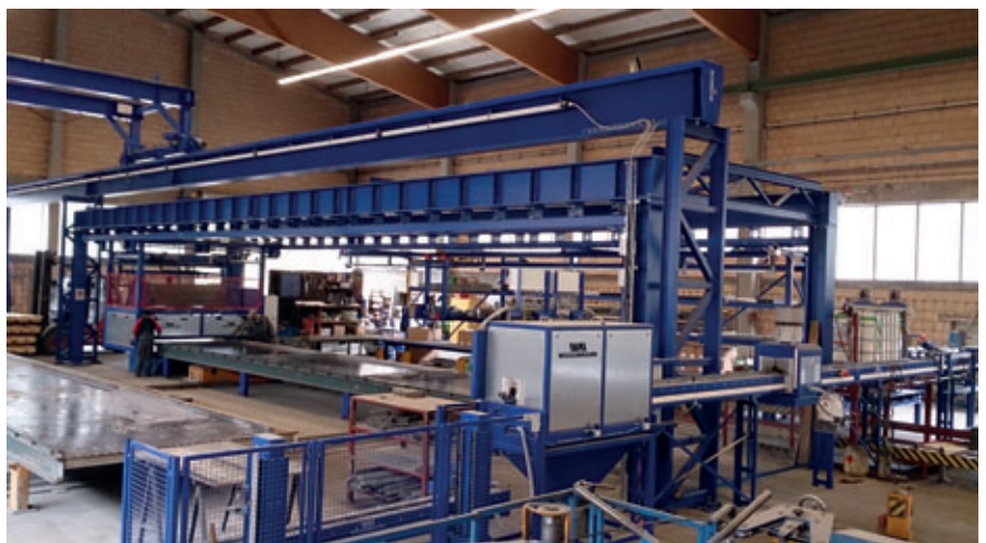
Effektivere und ergonomischere Arbeitsabläufe durch Einsatz eines Schalungstransportsystems mit Reiniger und Öler sowie verlässliche Anlagenverfügbarkeit durch neue Maschinen
