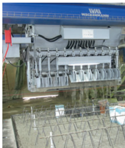
Links: ungleichmäßige Betonverteilung, mitfahrender Bedienstand. Rechts: Präziser und gleichmäßiger Betonaustrag mit einem neuen Betonverteiler von Weckenmann
