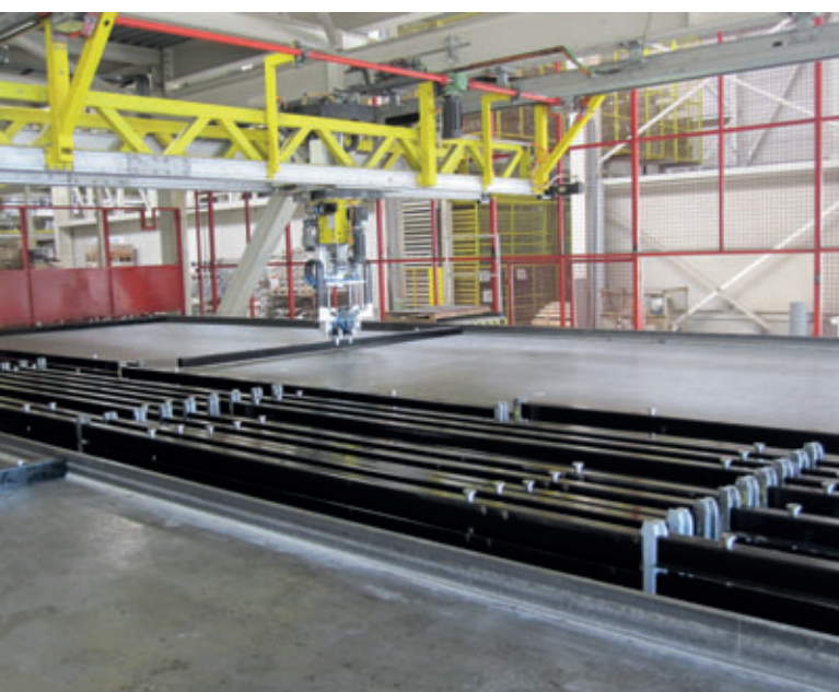
Modernisierung mit Schalungsroboter und Schalungssystemen mit integrierten Magneten
