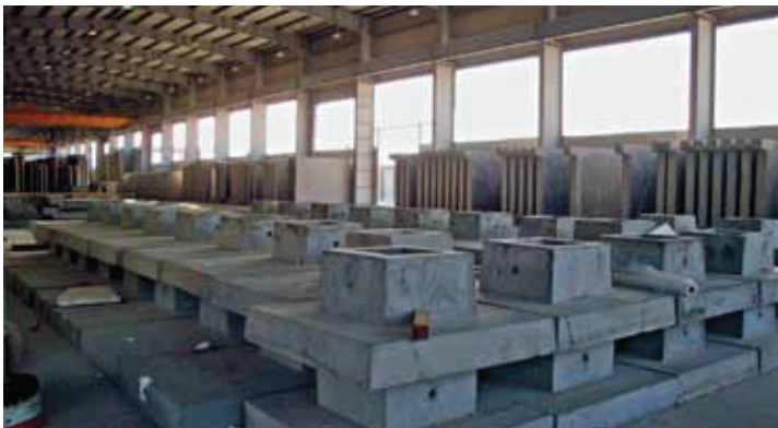
The tilting table production line is also used for the manufacture of various structural precast concrete elements. Ebenfalls mit Kipptischfertigung werden verschiedenartige strukturelle Fertigteilelemente produziert
