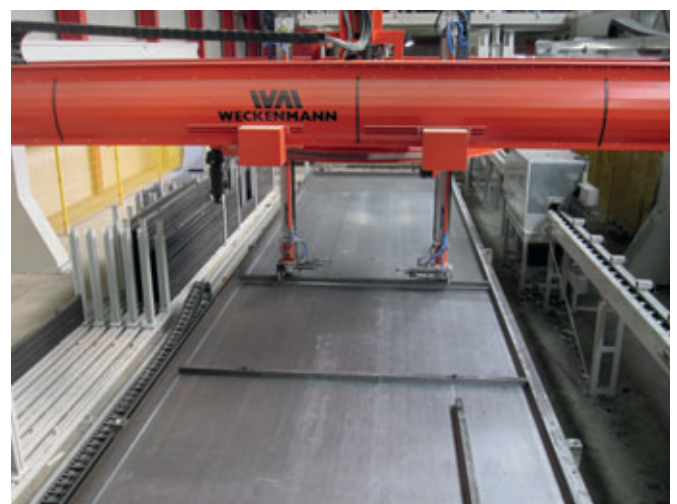
BE Beton Elemente Steißlingen: Der Weckenmann Twin-Z Entschal- und Einschalroboter
