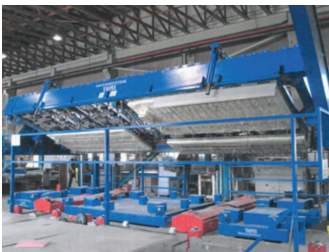
BFU Waldmössingen: Hochmoderne Saug-Wendetechnik für die Doppelwand-Fertigung
