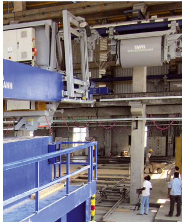
Egal, ob ein- oder zweigleisig angelegt: Die Kübelbahnen von Weckenmann bringen den Beton schnell und sicher dorthin, wo er in der Produktion gebraucht wird.
