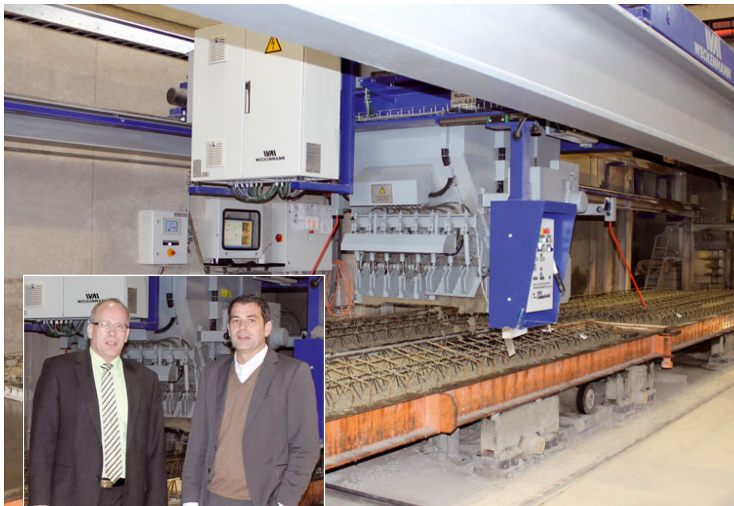
Mit den automatischen Betonverteilern von Weckenmann (Bild oben) hat die fdu Vertriebs- und Planungs GmbH unter der Leitung von Geschäftsführer Thomas Beike (linkes Bild, re.) und Projektleiter Benno Strack in vier Werken ihre Prozess- und Arbeitsabläufe optimiert.
