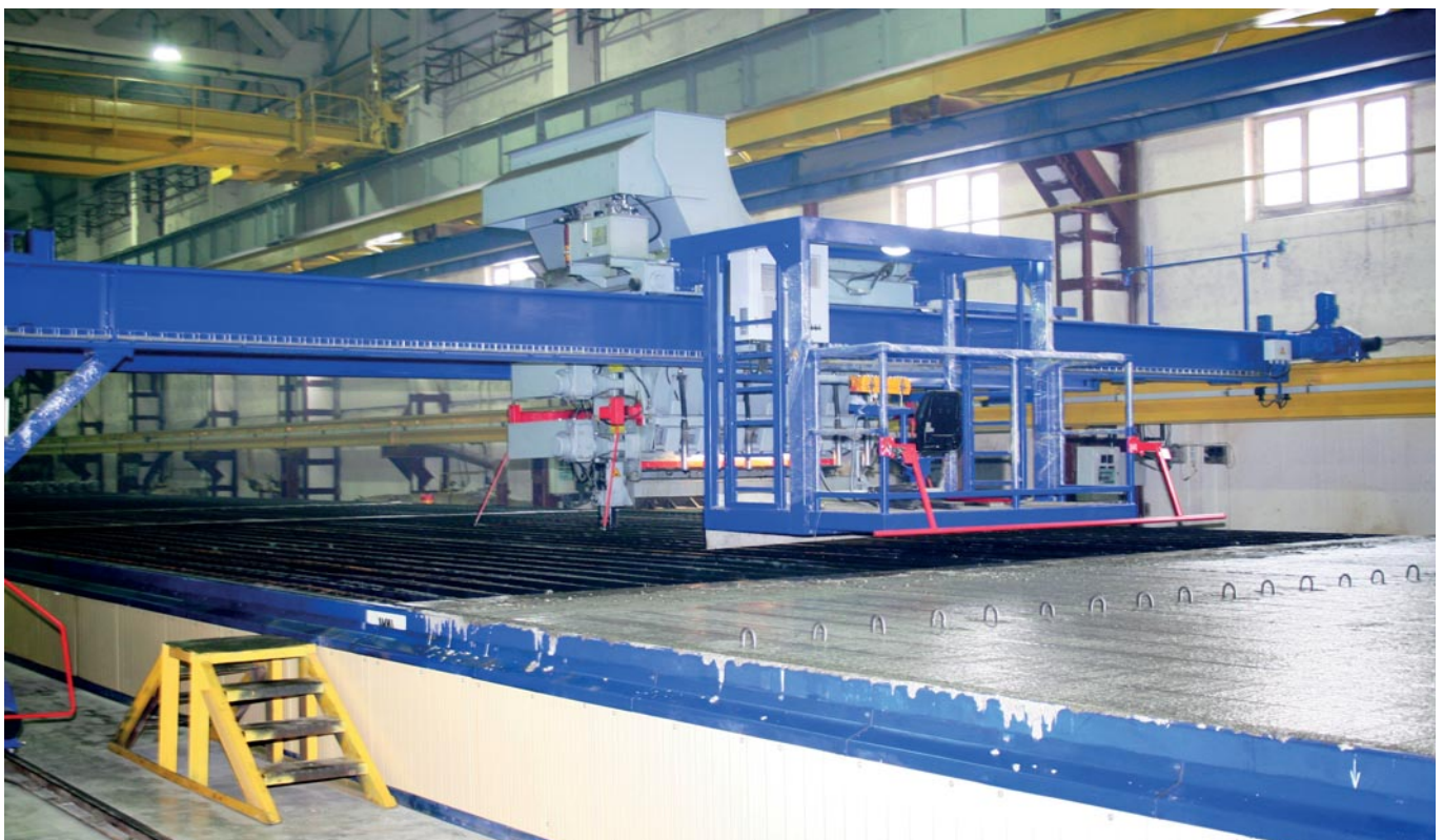
Rammpfahlfertigung bei TDSK Tomsk
