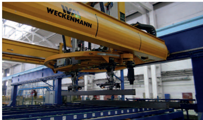
Опалубочный робот со двоянным Z-манипулятором отличается особым быстродействием
