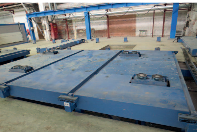
Комбинированная станция виброуплотнения с мощными электромагнитами
