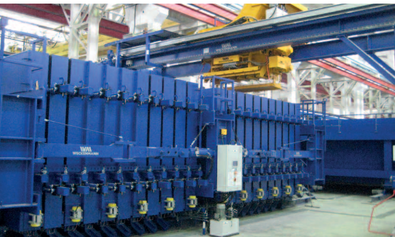
Кассетная опалубка идеально подходит для компактного производства стеновых панелей с двусторонней гладкой поверхностью
