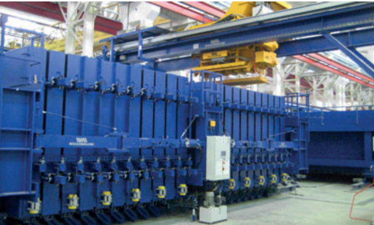
As formas em bateria são adequadas especialmente para a produção com requisitos mínimos de espaço de elementos de parede de alta qualidade de ambos os lados
