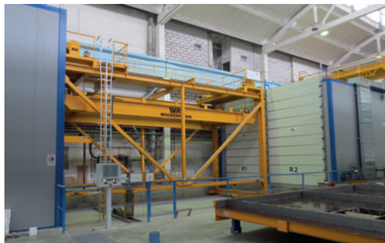
Câmara de cura com aquecimento a ar quente
