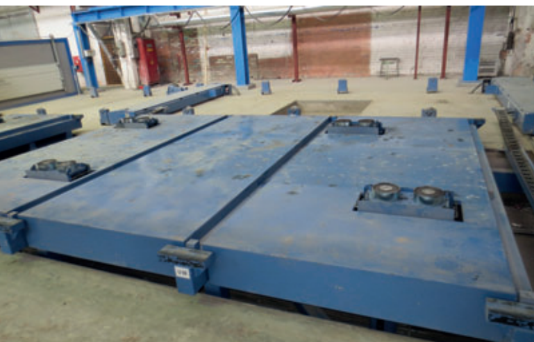
Estação vibratória-agitadora combinada com eletroímãs de alto desempenho
