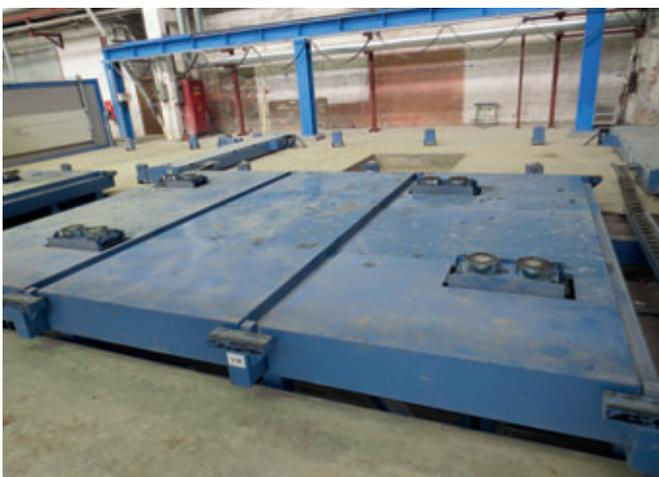
Estación combinada de vibración/agitación con electroimanes de alto rendimiento
