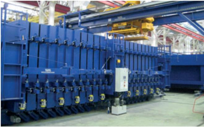
Los encofrados en batería son especialmente adecuados para la fabricación de elementos de muro con superficies lisas de encofrado a ambos lados y permiten ahorrar espacio.
