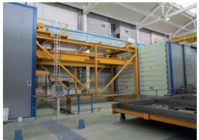
Cámara de fraguado con calefacción de aire caliente
