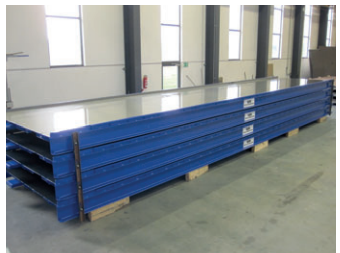
et après l'assainissement par Weckenmann : sablées et exemptes de rouille et de rayures.
