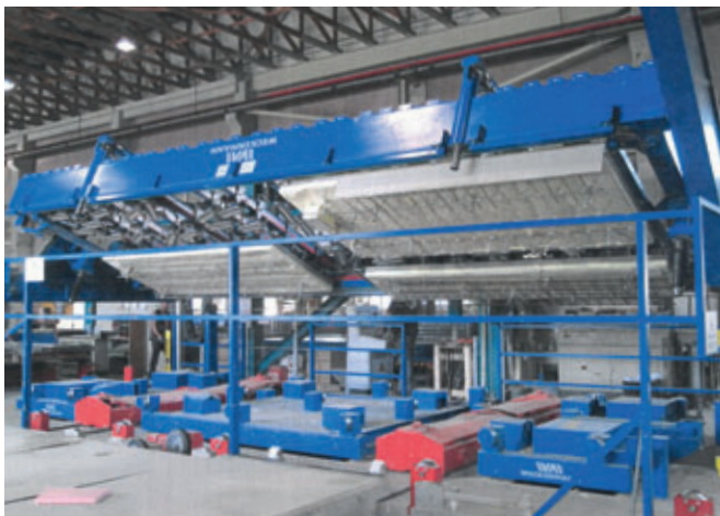
Técnicas de volteo altamente modernas mediante succión
