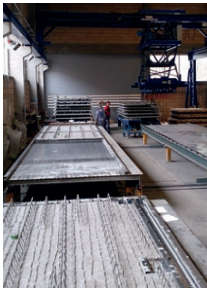
Depois: desmoldagem em duas posições de paleta e três postos de empilhamento e dois carros de extração
