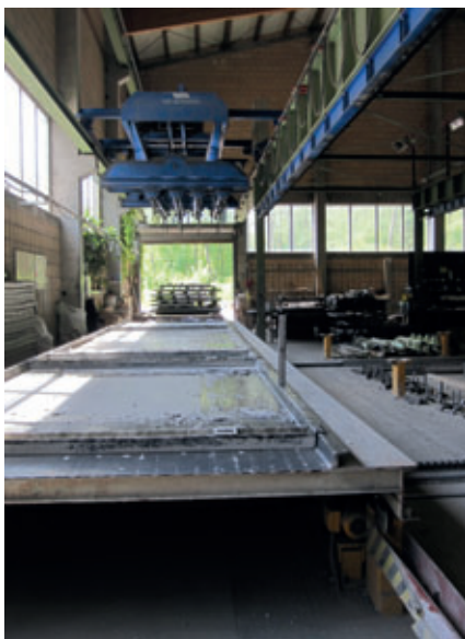
Anteriormente: desmoldagem apenas em uma posição de paleta e apenas um posto de empilhamento/carro de extração
