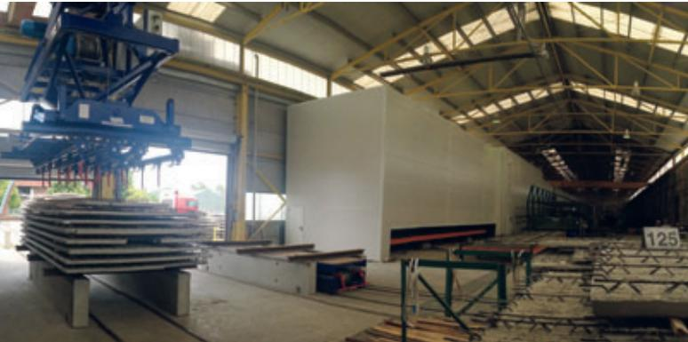
Quatre emplacements d'empilage pour les prédalles avec deux chariots transfert semi-automatiques
