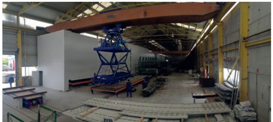
Appareil de levage avec dispositif de rotation pour le levage et le défilage des prédalles
