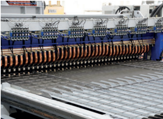
Instalación de soldadura de mallas FBE/158 de EVG
