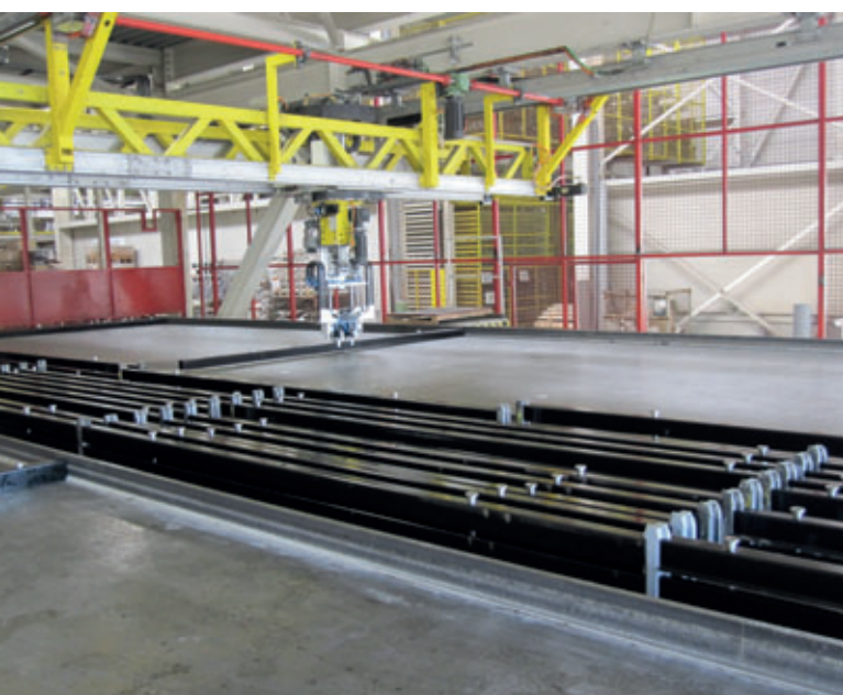
Modernisation à l'aide de robots et systèmes de coffrage à aimants intégrés
