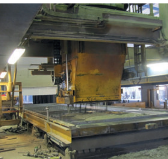
A gauche: distribution inégale du béton, poste de commande mobile. A droite: répartition homogène du béton avec un nouveau distributeur de Weckenmann
