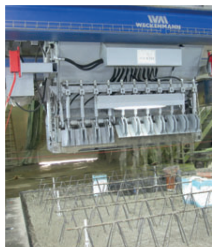
A gauche: distribution inégale du béton, poste de commande mobile. A droite: répartition homogène du béton avec un nouveau distributeur de Weckenmann
