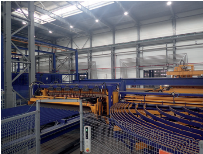
Máquina de soldagem de vigas treliçadas do tipo HFBE/158
