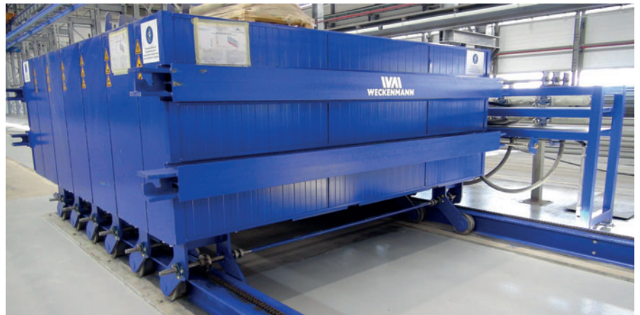
Encofrado de escaleras
