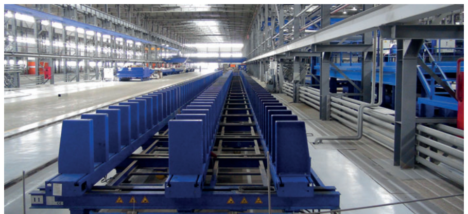
Encofrado para pilares
