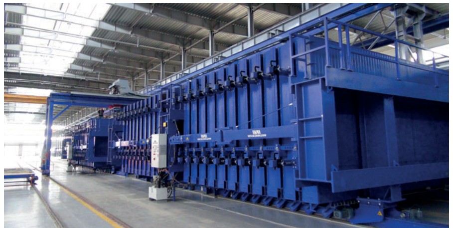
Encofrado en batería
