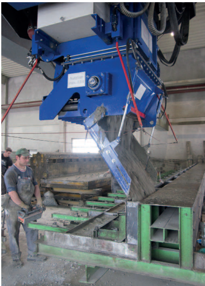
Todas as alturas de moldes podem ser dirigidas agora com flexibilidade e com maior rigor, com apenas um operador, com o novo distribuidor de concreto
